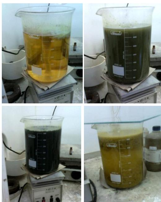
**Figura 12.** Reação de complexação do titânio com a 8-hidroxiquinolina
