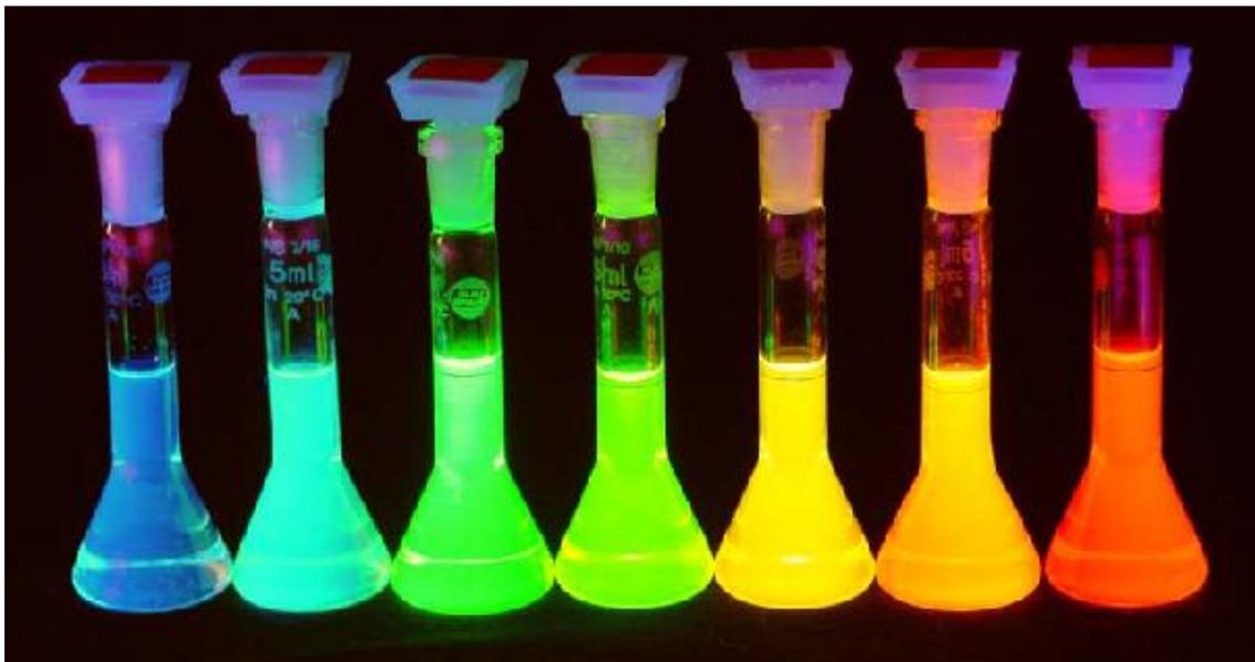
**Figura 4.** Suspensões de pontos quânticos de CdSe de diferentes diâmetros. Do menor (esquerda) ao maior diâmetro. Retirada de <sup>[30]</sup>.
