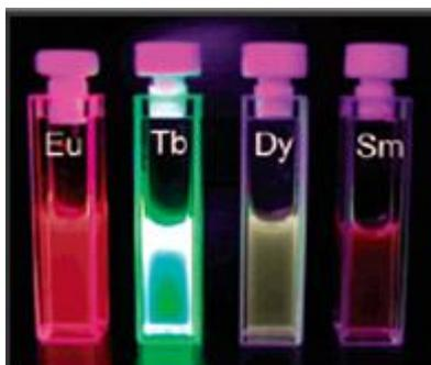
**Figura 6.** Complexos luminescentes de  $\text{Eu}^{3+}$ ,  $\text{Tb}^{3+}$ ,  $\text{Dy}^{3+}$  e  $\text{Sm}^{3+}$ . Retirada de <sup>[33]</sup>.
