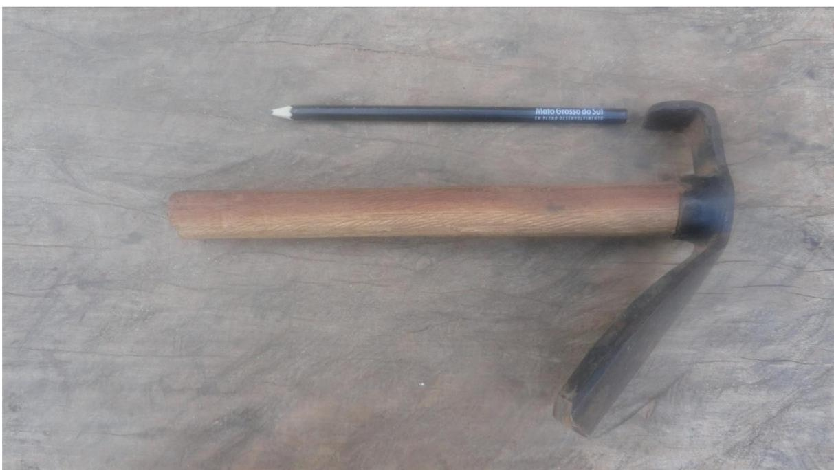
Figura 8 do anexo: Enxogoiva, ferramenta utilizada na fabricação de canoa.
