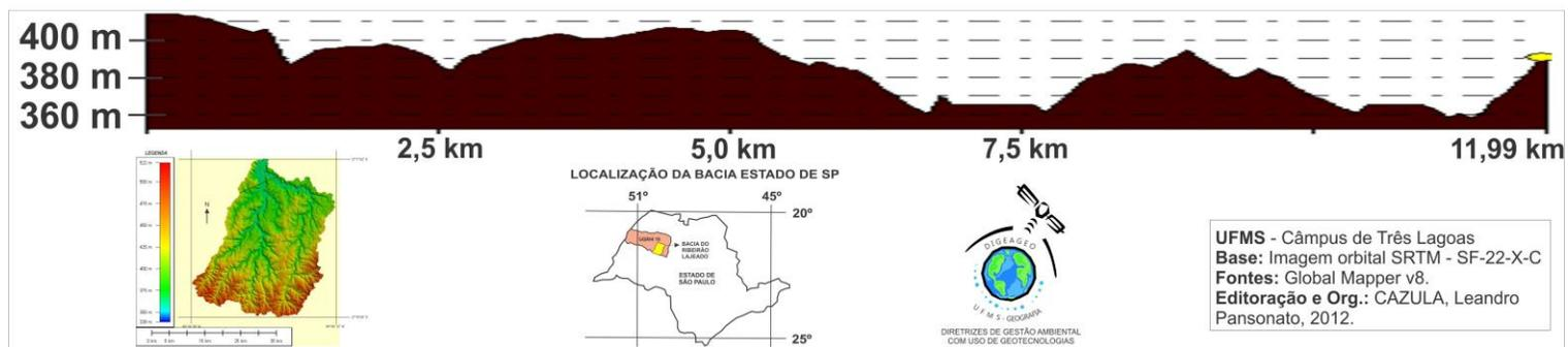
**Figura 22:** Perfil transversal próximo da foz da bacia hidrográfica do Ribeirão Lajeado.
