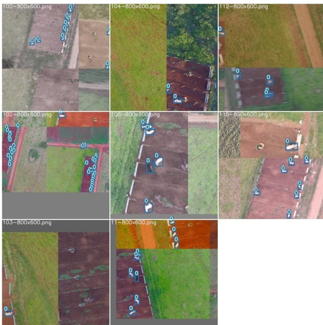
Figura 8– Resultados da aplicação do aumento de dados com CutMix e Mosaico nas imagens utilizadas no treino da YOLOv5.
