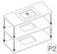
2 - DESLIZE AS TRÊS LÂMINAS DE PAPEL NO FOLDSCOPE COMO INDICADO PELA SETA. LÂMINAS DE VIDRO TAMBÉM PODEM SER USADAS COM CUIDADO. ENCAIXE A LÂMINA NAS ABERTURAS PARA MAIOR ESTABILIDADE.
