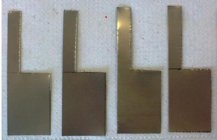
Figura 5 - Placas de Ti prontas para polimento.
