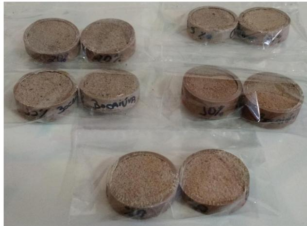
**Figura 13** - Amostras cilíndricas com e sem EB tratado.
