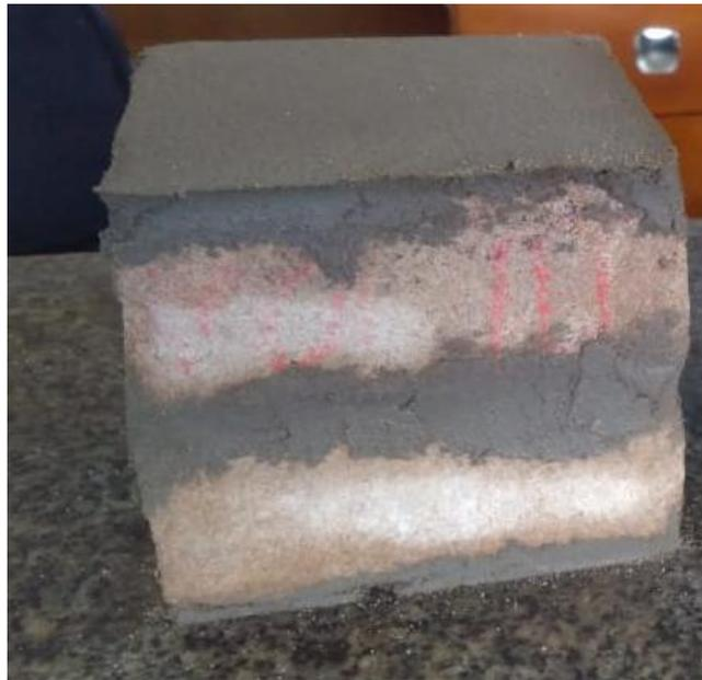
**Figura 10** - corpos de prova pronto para ensaio de compressão
