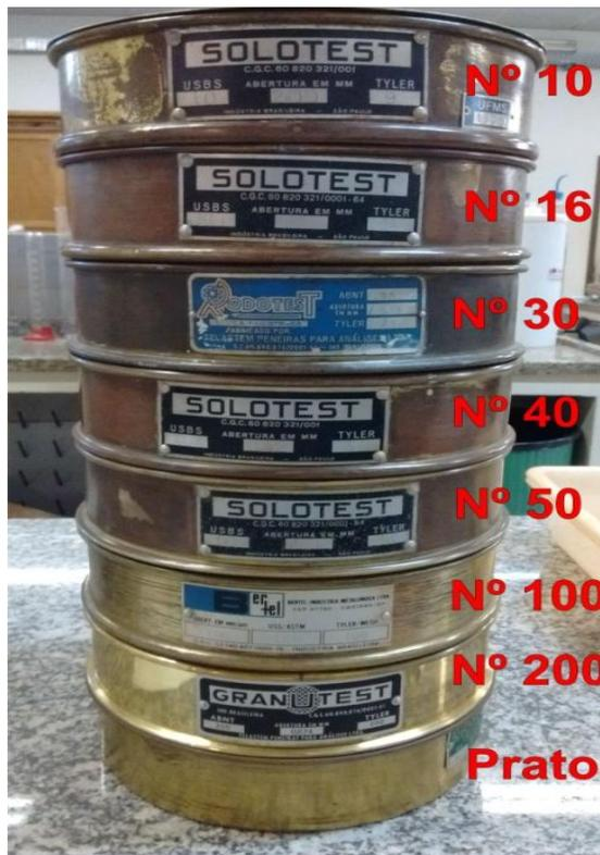
**Figura 7** - Série de peneira utilizada no ensaio.
