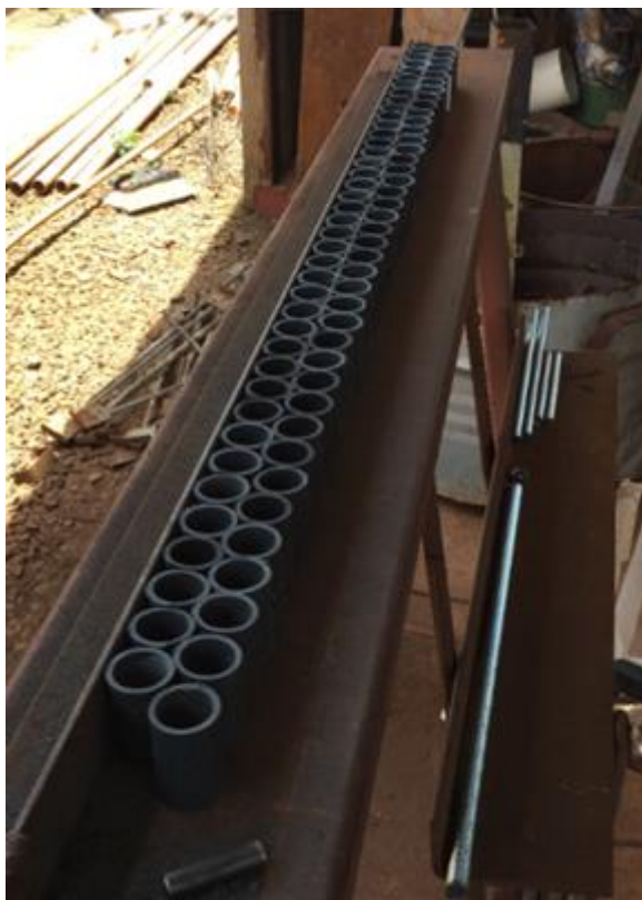
Figura 12 – Molde de PVC utilizado na confecção dos corpos de prova.
