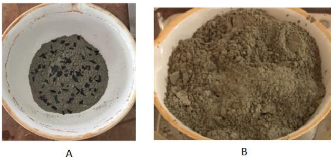
Figura 24 – (A) GO em flocos disperso na massa de cimento. (B) Mistura de areia, cimento e GO em flocos.
