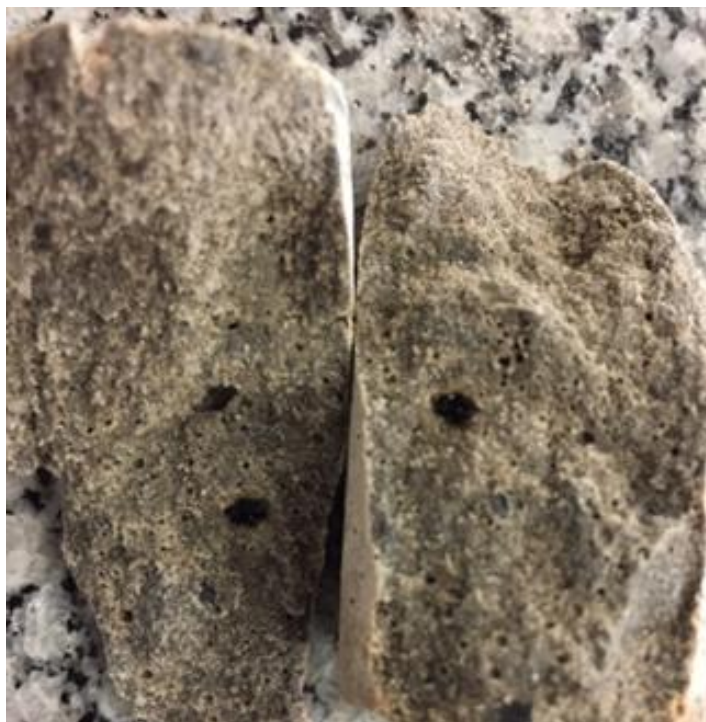
Figura 50 – Flocos de GO aglutinado presente em corpo de prova rompido do grupo GO4 em flocos.
