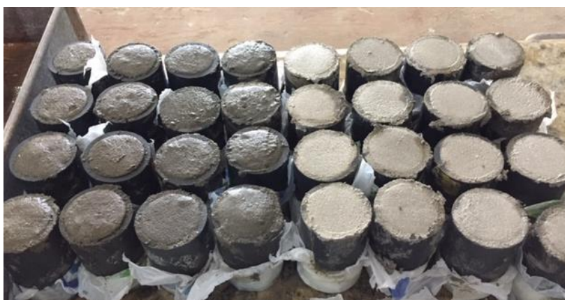
Figura 41 – Corpos de prova úmidos a esquerda (RGO em areia) e secos a direita (RGO em cimento).
