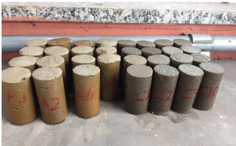
Figura 42 – Corpos de prova de RGO em areia a esquerda e RGO em cimento a direita.
