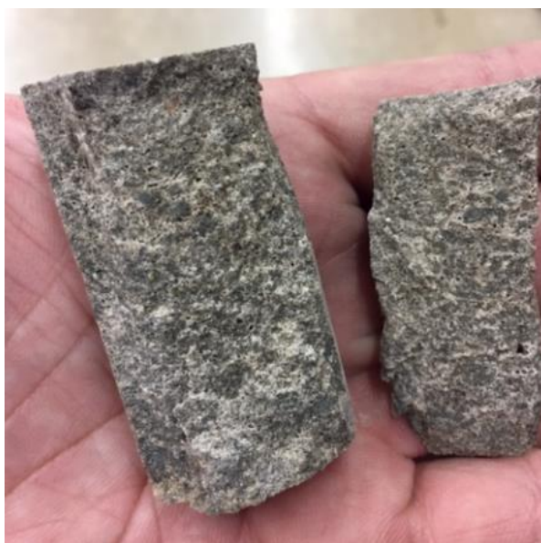
Figura 45 – CP com RGO em cimento após o ensaio de compressão axial.
