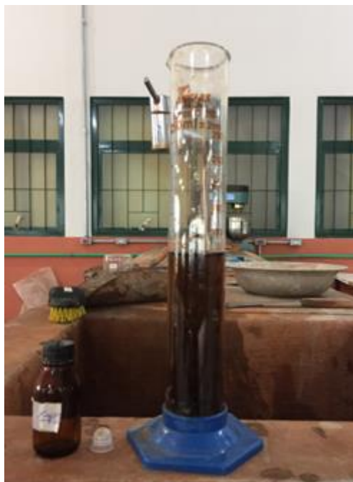
Figura 27 – Água de mistura mais GO para 0,02% de GO em massa.
