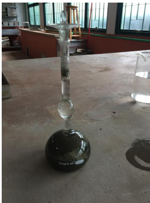
Figura 20 – Frasco de Le Chatelier preenchido com querosene e cimento.
