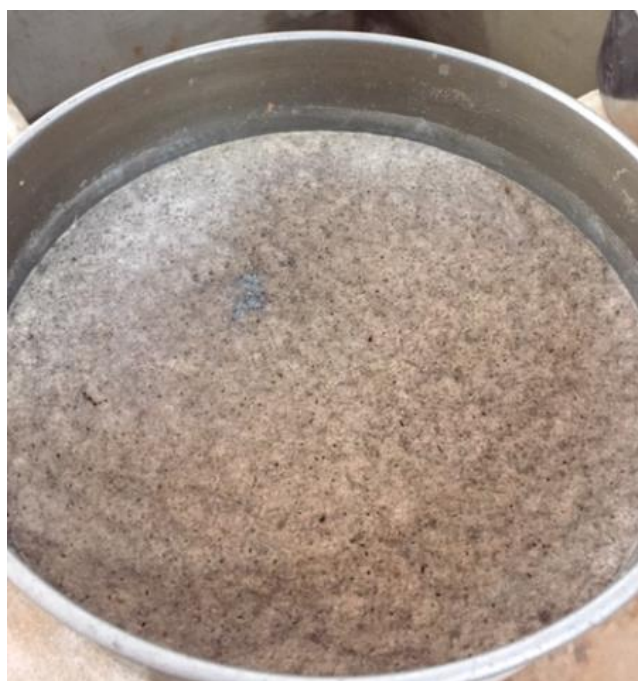
Figura 31 – Óxido de grafeno reduzido em areia após a secagem da mistura com teor de 0,04% de GO.
