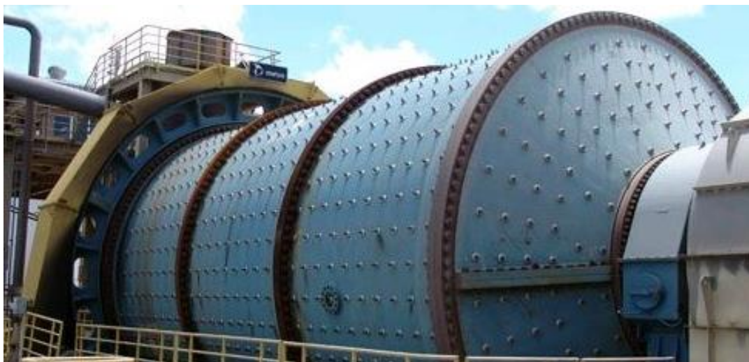
Figura 2 – Moinho de bolas utilizados no processo de moagem para fabricação do cimento. Fonte: (B2B Máquinas, 2018)
