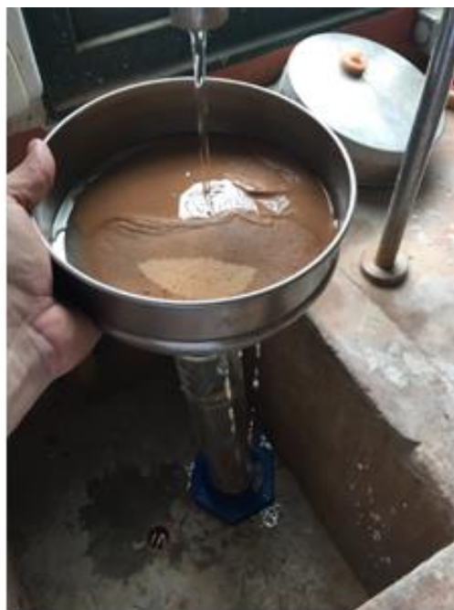
Figura 17 – (A) Material utilizado para determinação do Teor de Pulverulentos. (B) Execução do ensaio para determinação do Teor de Pulverulentos.
