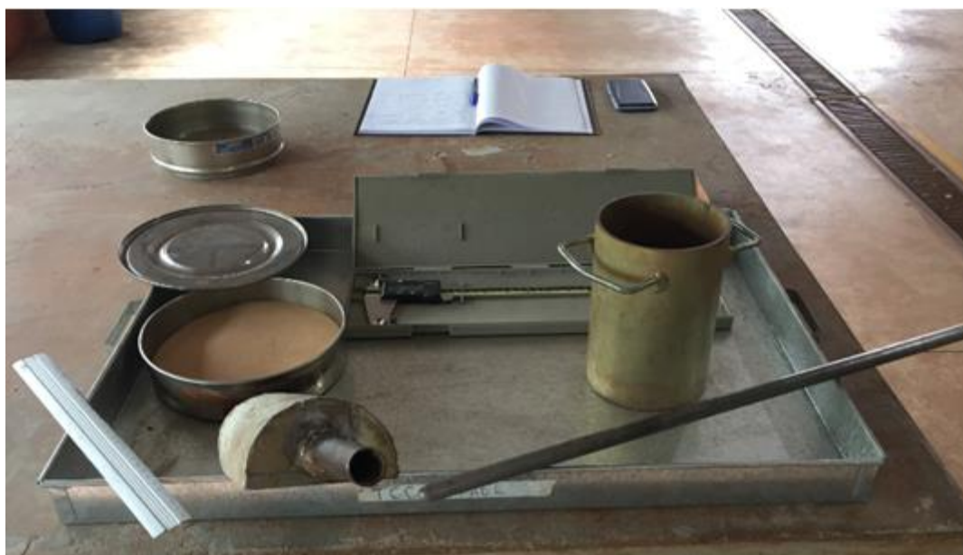
Figura 16 – Materiais utilizados na determinação da Massa Unitária do agregado miúdo.
