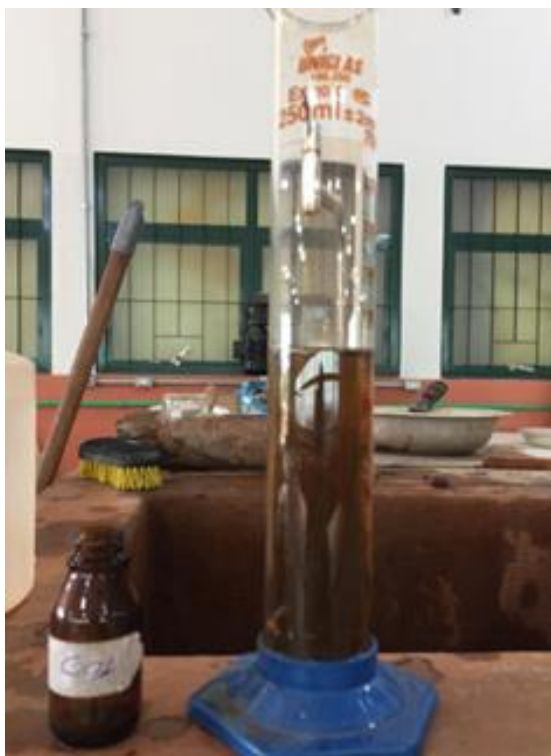
Figura 26 – Água de mistura mais GO para 0,01% de GO em massa.
