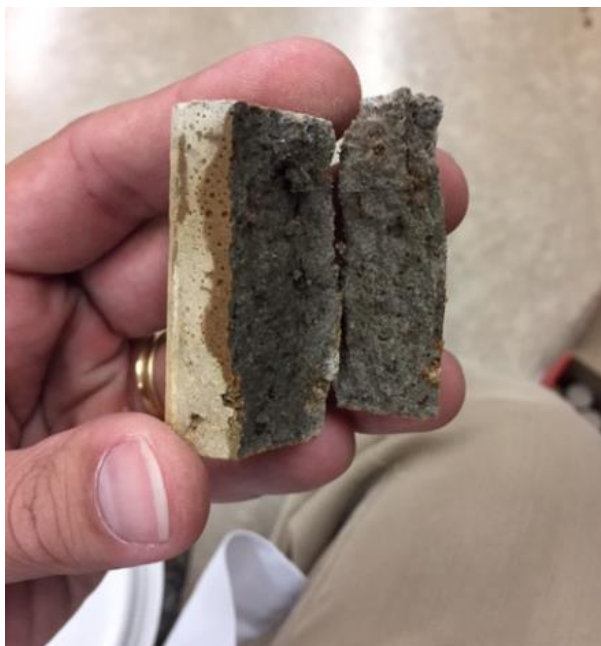
Figura 44 – Água confinada no interior do CP observada após o ensaio de compressão axial.
