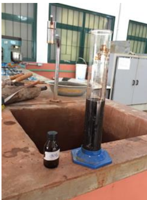
Figura 28 – Água de mistura mais GO para 0,04% de GO em massa.
