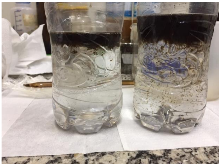
Figura 30 – Solução aquosa de hidróxido de sódio e 0,01% de GO (esquerda) e 0,02% de GO (direita) após agitação de cinco minutos.
