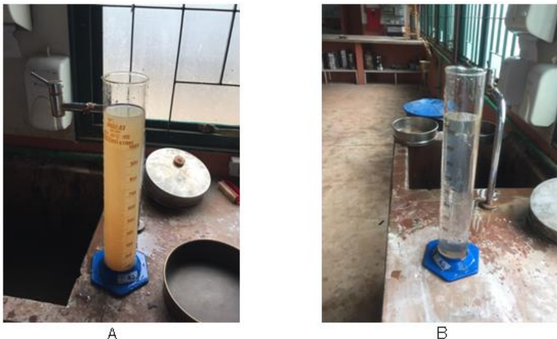
Figura 18 – (A) Proveta com água suja indicando o início do peneiramento. (B) Proveta com água limpa indicando o final do peneiramento.
