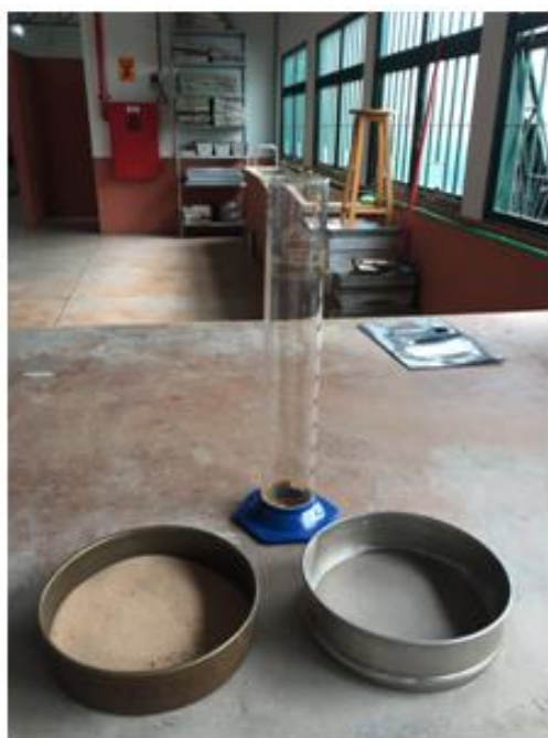
Figura 17 – (A) Material utilizado para determinação do Teor de Pulverulentos. (B) Execução do ensaio para determinação do Teor de Pulverulentos.
