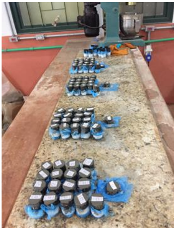
Figura 29 – Corpos de prova moldados com argamassas e GO dispersos em solução.
