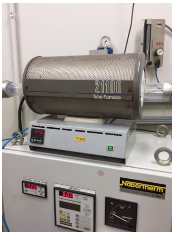
Figura 32 – Redução do óxido de grafeno em cimento através de tratamento térmico.
