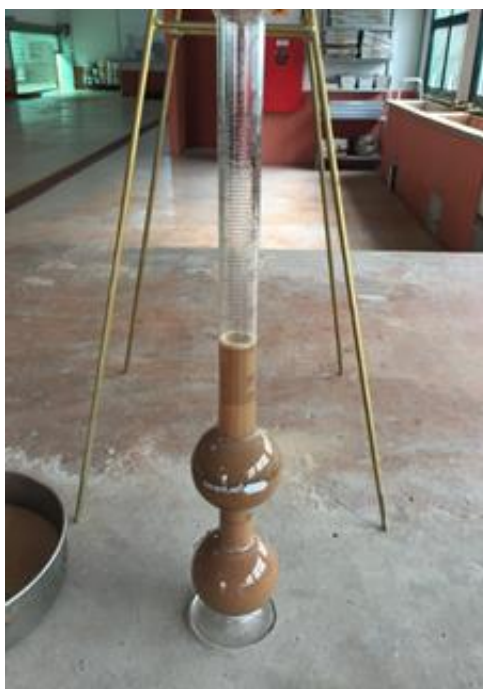
Figura 15 – Frasco de Chapman preenchido com a mistura areia e água.
