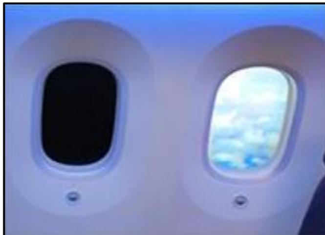
**Figura 4.** Janela eletrocromica de aeronave, invenção patenteada pela Gentex, representando um estado extremo escurecido e um estado claro.<sup>13</sup>
