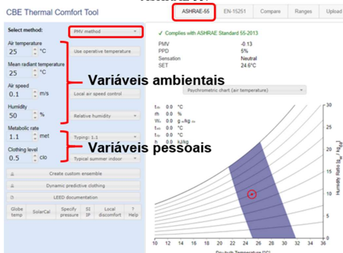
Figura 27 - Ferramenta Comfort Tool para análise de conforto pelo método PMV da ASHRAE 55.
