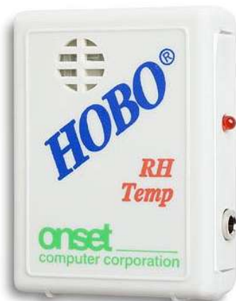
Figura 24 - Hobo RH/Temp modelo H08-003-02.
