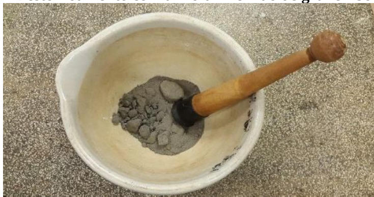
Figura 9 - Destorroamento com almofariz e mão de gral emborrachada.
