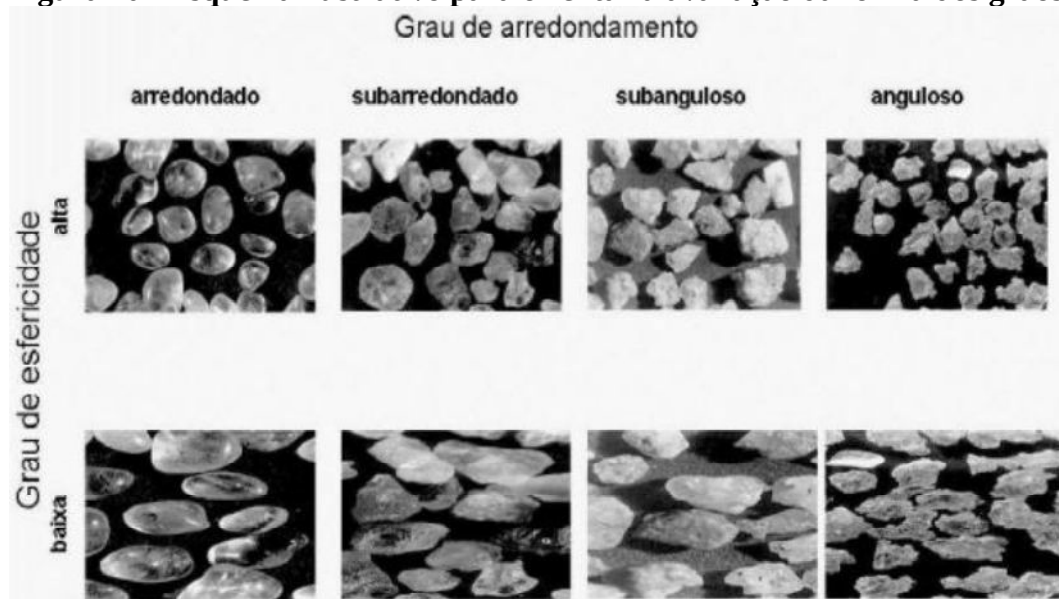
Figura 20 - Esquema ilustrativo para orientar a avaliação da forma dos grãos.
