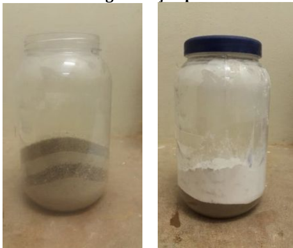
Figura 10 – Recipientes com as frações de areia e do CH com a cinza de caldeira para homogeneização prévia.
