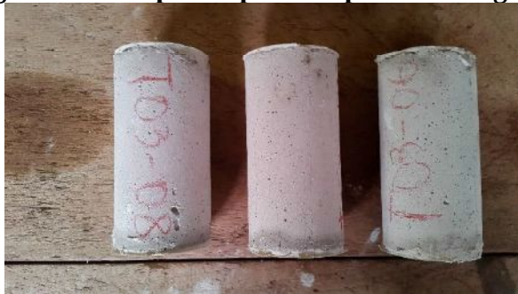
Figura 11 - Corpos de prova capeados com gesso.
