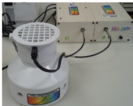
Figura 4.4: Detector interligado por cabos de fibra óptica ao equipamento de VIS-NIR
