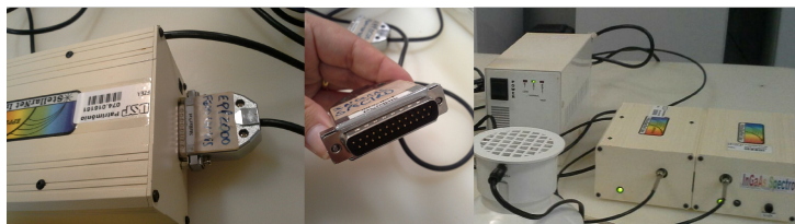
Figura 4.5: Conversor interligado por portas paralelas DB25 ao VIS-NIR
