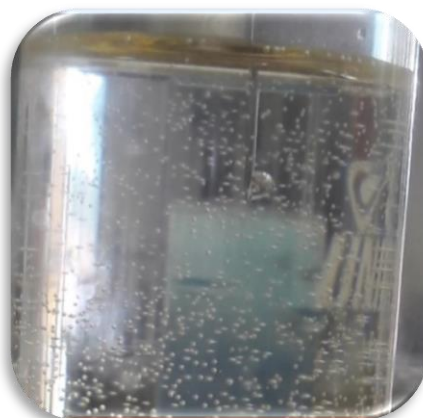
FIGURA 13 – Extração DI-SDME em água ultrapura com elevação na temperatura e velocidade de agitação
