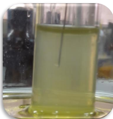
FIGURA 5 – Formação da microgota no modo de operação DI-SDME em uma amostra de 1mL de caldo de cana filtrado + 9mL de água ultrapura. Homogeneizou-se a amostra. Referência: autor.
