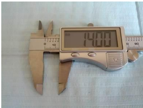
Figura 2 – paquímetro digital calibrado em 14 mm
