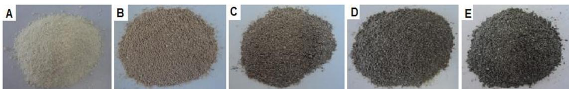
**Figura 9** - Imagens das nanopartículas de TiO<sub>2</sub> e TiO<sub>2</sub>/Ag. (A) TiO<sub>2</sub> SG; (B) TiO<sub>2</sub> SG 0,5% Ag; (C) TiO<sub>2</sub> SG 1,0% Ag; (D) TiO<sub>2</sub> SG 2,0% Ag; (E) TiO<sub>2</sub> SG 4,0% Ag.
