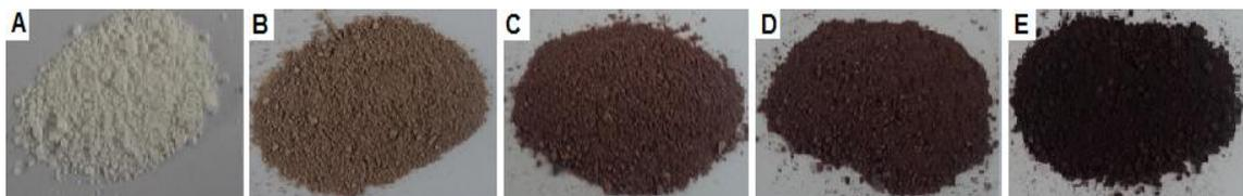
**Figura 8** - Imagens das nanopartículas de TiO<sub>2</sub> e TiO<sub>2</sub>/Ag. (A) TiO<sub>2</sub> P25; (B) TiO<sub>2</sub> P25 0,5% Ag; (C) TiO<sub>2</sub> P25 1,0% Ag; (D) TiO<sub>2</sub> P25 2,0% Ag; (E) TiO<sub>2</sub> P25 4,0% Ag.
