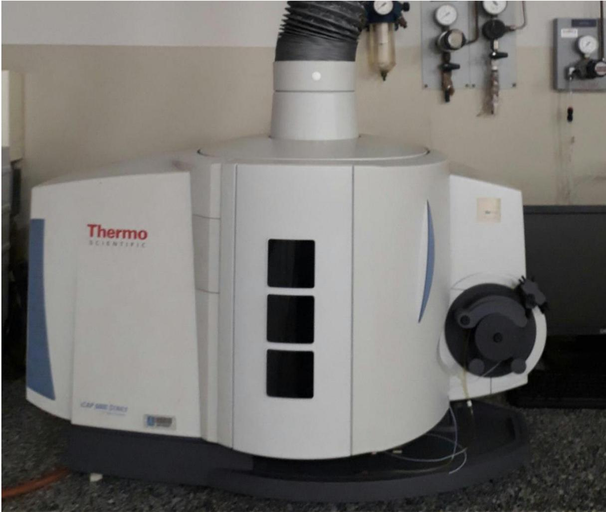
**Figura 8:** ICP OES utilizado para determinação do teor de microelementos e macroelementos na amostra e curva de calibração.
