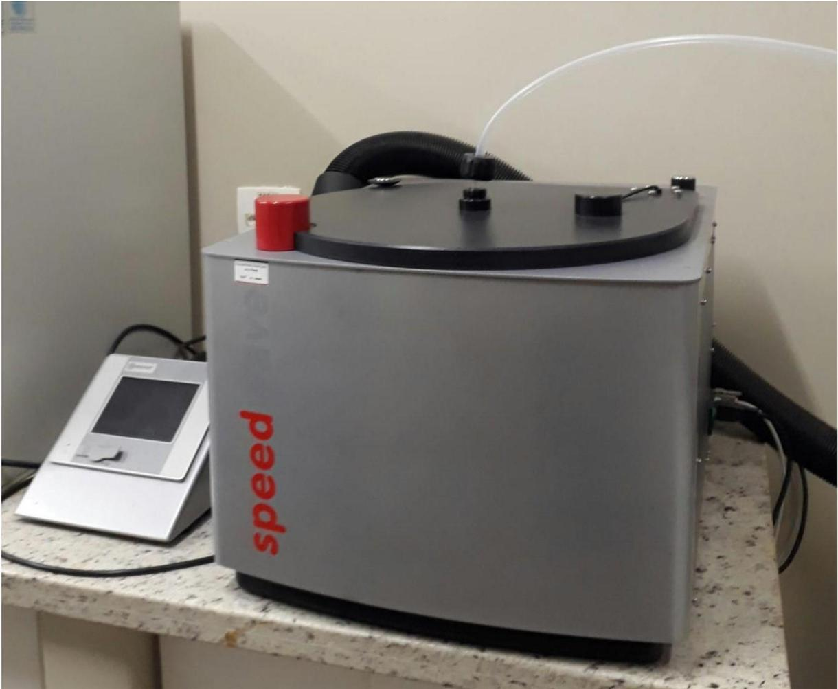
**Figura 4:** Micro-ondas Speedwave Berghof, Alemanha utilizado.
