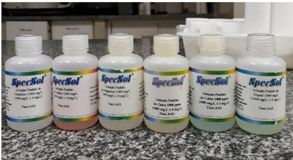
**Figura 7:** Solução padrão mono elementar com concentração de 1000 mg L<sup>-1</sup> SpecSol<sup>R</sup> para Al, Ca, Mg, Zn, Cu e Ni utilizadas.
