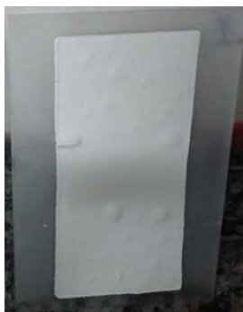
Figura 40 - Massa niveladora 26S30G10AC a após o teste de absorção de água.
