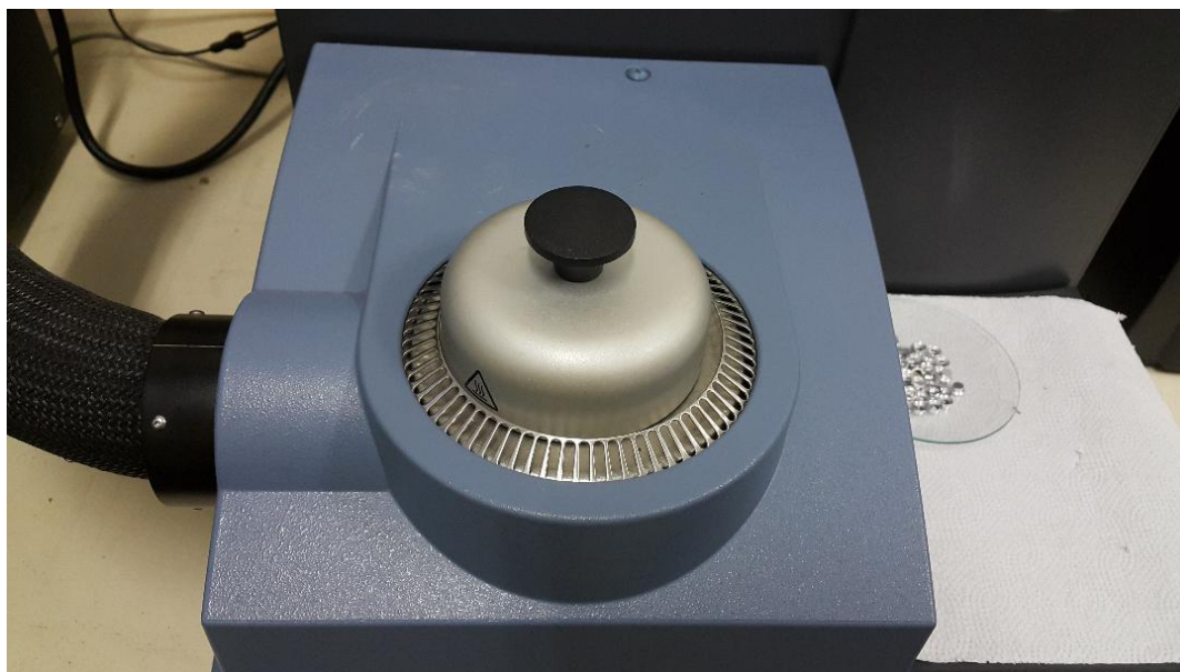
Figura 15 - Forno do DSC tampado
