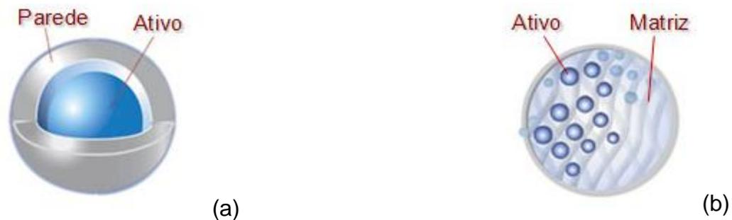
Figura 5. Comparação entre os tipos de partículas: a) microcapsulas e b) microesferas
