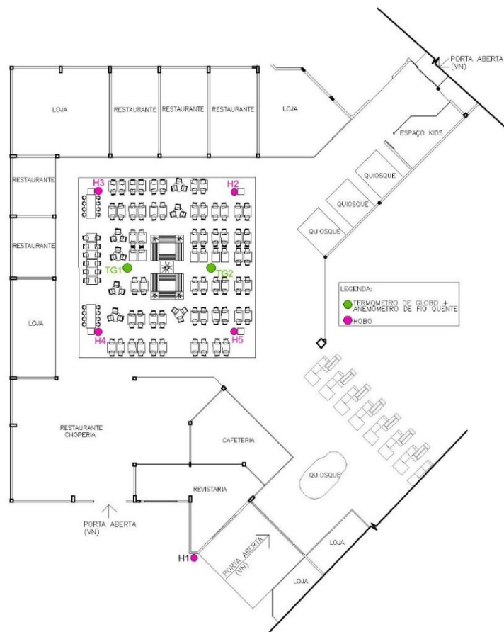
Figura 3.15 - Planta com posicionamento dos sensores no experimento ( Hipercenter 1 )
