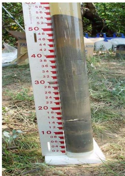
Figura 4.2 – Amostrador “*Core*” para sedimentos.
