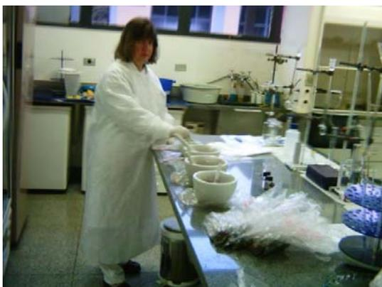
Figura C.1 - trituração das amostras de sedimentos
