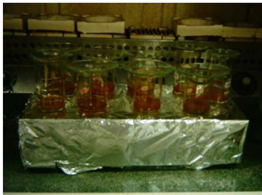
Figura C.2 - .digestão dos metais em sedimentos
