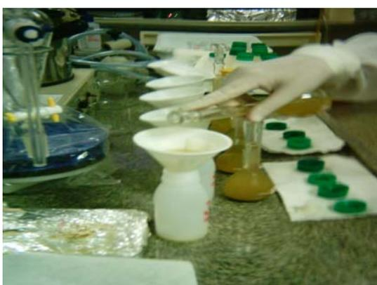
Figura C.3 - filtração após digestão dos sedimentos
