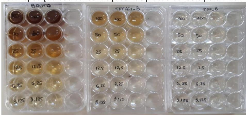
Foram realizados testes nas concentrações: 100; 50; 25; 12,5; 6,25 e 3,125 em % (v/v), e um controle de água mineral também com sal marinho adicionado, como controle. Os resultados foram analisados através da comparação da população viva e morta de indivíduos e o  $IC_{50}$  foi calculado utilizando o software Trimmed Spearman-Karber Method versão 1.5.
