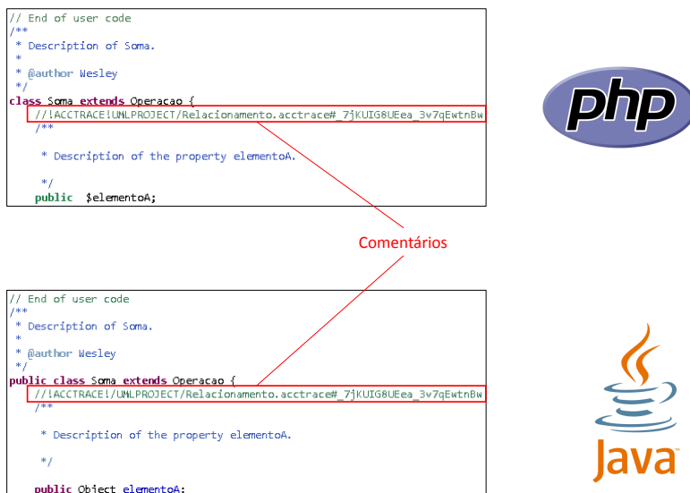
Figura 4.4: Exemplo de trechos de códigos gerados automaticamente para a linguagem Java e PHP com os comentários de apoio à implementação de acessibilidade
