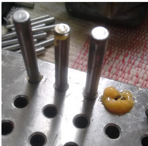
Figura 47 – Vazamento da PUMO pelas folgas do molde
