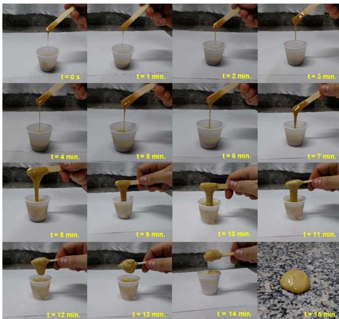
Figura 25 – Exemplo da mudança da adesividade da PUMO em função do tempo, do instante t = 0s (mistura dos componentes) ao t = 15 \text{ min.} (estado de moldagem – perda de adesividade)
