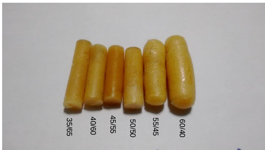
Figura 49 – Detalhe da expansão encontrada
