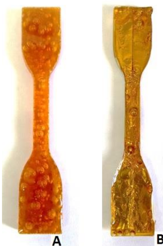
Figura 46 – Amostra confeccionada sem a vedação de alumínio
