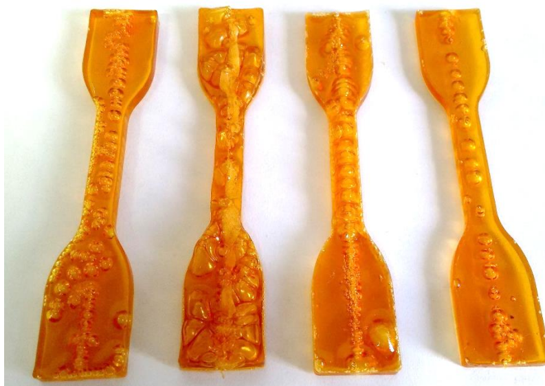
Figura 44 – Detalhe dos defeitos encontrados que sugerem um certo padrão. Formulação 5, R_m 1,0, rota de fabricação A
