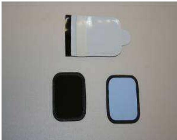
Figura 7 - Placas de fósforo foto estimulável invólucro opaco a luz e impermeável
