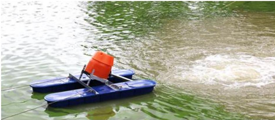
Figura 9 – Aerador propulsor em funcionamento (<http://www.agricotec.com.br/>).
