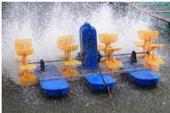
Figura 7 – Aerador de superfície – aerador de pás em funcionamento (<http://escamaforte.com.br/>).
