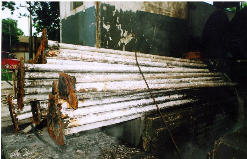
**Figura 4.4 – Tubos de fogo impregnados por crosta de carbonato de cálcio retirados para reforma.**
