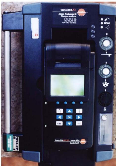
Figura 4.2 – Analisador de Poluentes Atmosféricos da TESTO – 350 XL.
