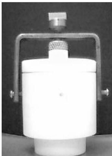
**Figura 2:** Célula de Teflon, com uma janela plana de  $\text{CaF}_2$  na parte inferior, empregada nos experimentos de reflectância na região espectral do infravermelho.
