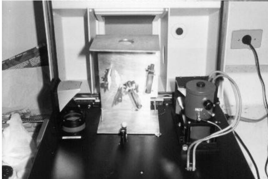
**Figura 5:** Banco óptico de reflectância acoplado a um espectrofotômetro de FTIR, modelo MB100 (Bomem)
