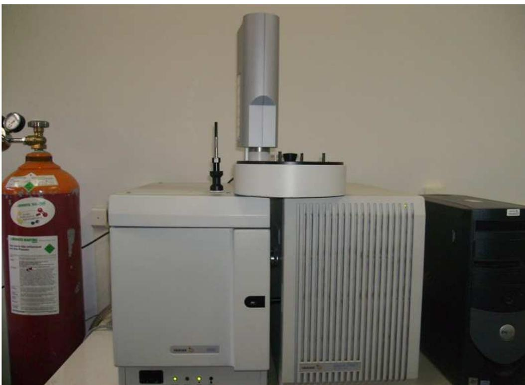
**FIGURA 45:** Cromatógrafo a Gás acoplado ao Espectômetro de Massa (com a fibra no injetor).
