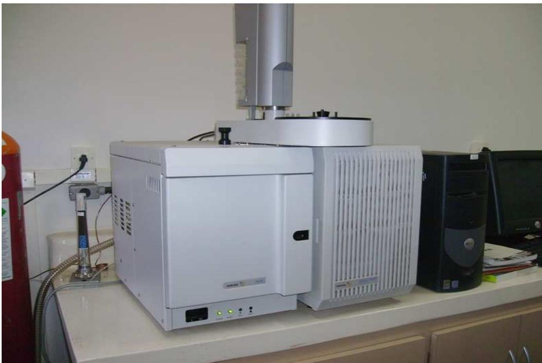
**FIGURA 44:** Cromatógrafo a Gás acoplado ao Espectômetro de Massa.
