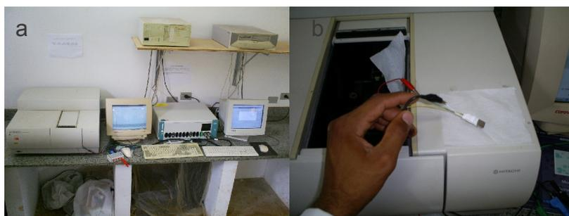
**Figura 3-2.** Visão frontal do arranjo experimental para o estudo fotoeletroquímico e espectrométrico: a) espectrofotômetro, monitor de visualização das leituras espectrofotométricas, potenciostato e monitor de visualização da leitura eletroquímica; b) visão do eletrodo de trabalho e câmera escura do espectrofotômetro com a tampa aberta.
