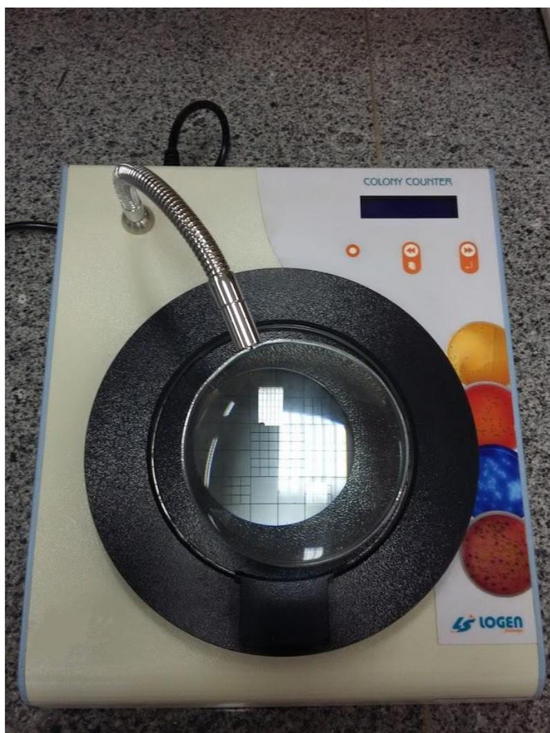
**Figura 6:** Contador de colônias eletrônico/digital utilizado na pesquisa
