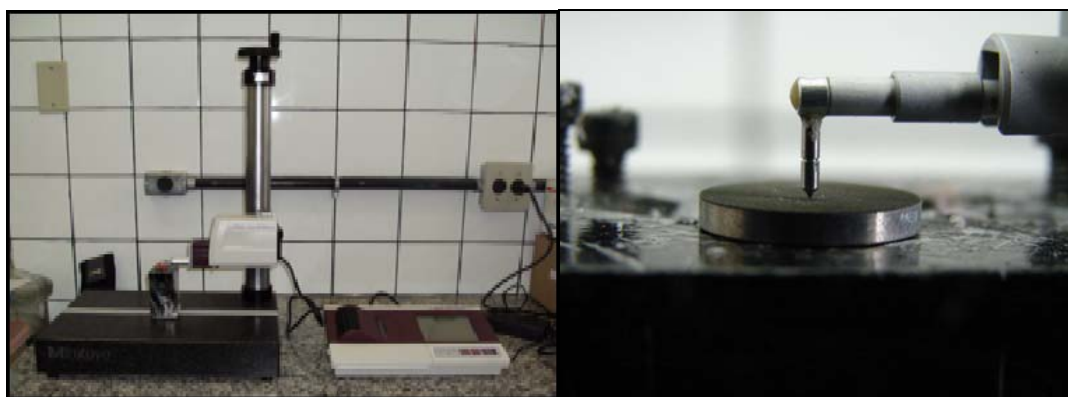
Figura 4: Fotografia ilustrando o aparelho de rugosímetro – utilizado para análise da Rm (Contact AngleSystem, video-based Dataphysics) - (FOAr UNESP-Araraquara-SP).
