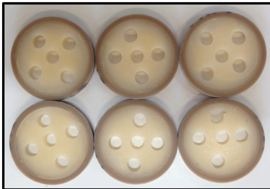
Figura 1. Moldes de resina acrílica utilizados no experimento com 3mm de altura e 4 mm de diâmetro.
