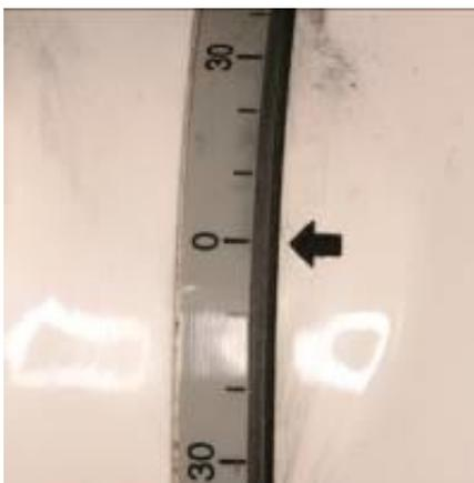
Figura 8 - Marca no goniômetro para o ângulo vertical de 0 grau.
