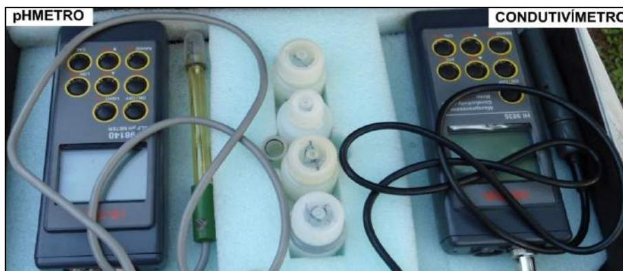
Foto 1 - pHmetro e Condutivímetro utilizados na aquisição dos parâmetros físico-químicos das águas.
