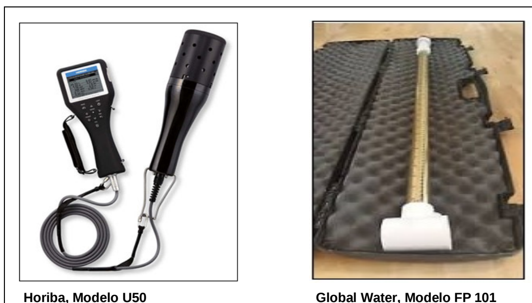
Figura 3: Medidor Multiparâmetro de Qualidade de Água Horiba, Modelo U50 e Medidor de Fluxo de Água Global Water, Modelo, FP 101.
