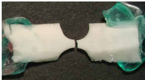
Figura 10 – Espécime após ensaio de tração
