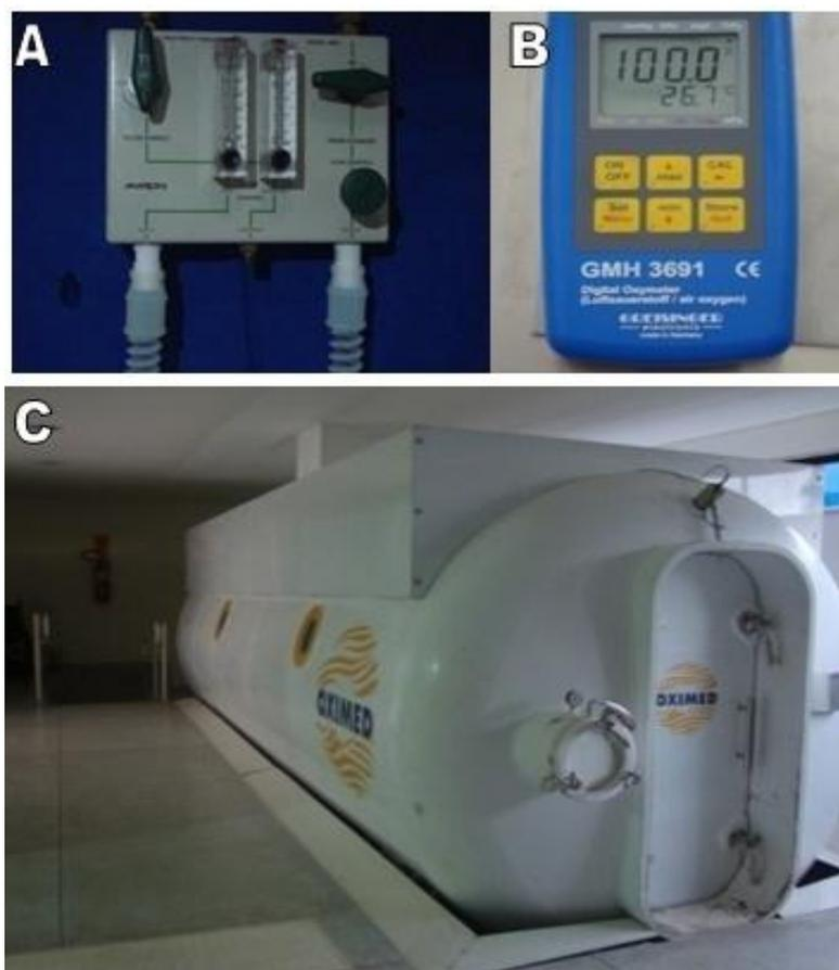
Figura 8 - A: Fluxômetro no interior na câmara, para controle do volume de oxigênio na entrada. B: Oxímetro digital do painel de controle da câmara onde é observada a saturação de oxigênio a 100% no interior da caixa de experimento. C: Câmara multiplace (OXIMED-MS). Ano e modelo 2001 Metalúrgica União – ES.
