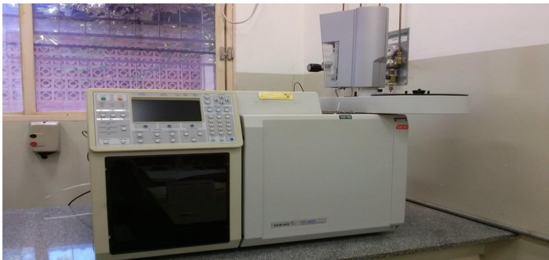
Figura 13: Cromatógrafo gasoso Varian CP – 3800
