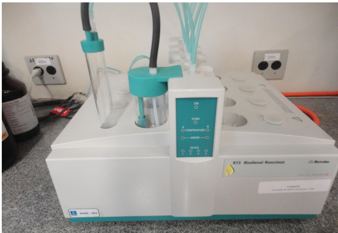
Figura 14: Equipamento Rancimat - METROHM 873.
