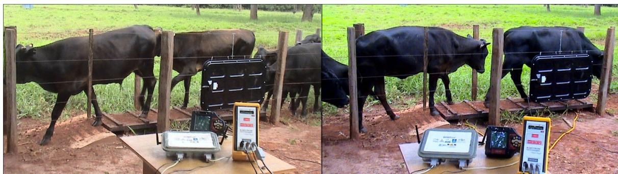
Figura 3 – Animais entrando e saindo da praça de alimentação através da balança de passagem. Em cima da mesa estão posicionados o receptor da balança e o dispositivo de identificação RFID.
