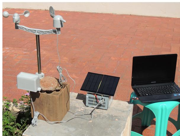
Figura 22 – Estação meteorológica construída para o projeto.
