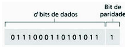
Figura 2.8: Verificação usando um único bit de paridade. Retirado de [41].
