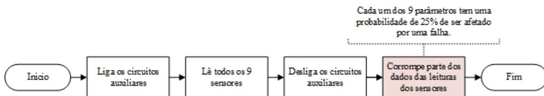
(b) Processo de leitura dos sensores na estação meteorológica com a injeção de falhas. Após a leitura dos sensores, os dados sofrem alterações de acordo com uma porcentagem definida de injeção de falhas.
