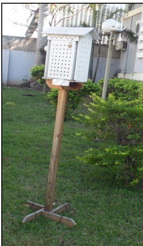
**Figura 1:** Abrigo meteorológico utilizado
