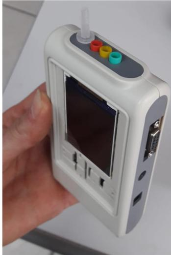
**Figura 3: Monitor multiparamétrico portátil, para registro do ECG**
