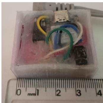
**Figura 10: Foto do dispositivo encapsulado na caixa plástica, medindo 3,5 mm x 4,0 mm x 1,5 mm.**
