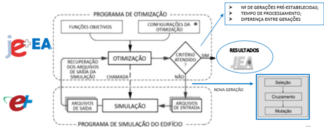
Figura 13 – Procedimento de execução do algoritmo genético de otimização dentro de todo o processo
